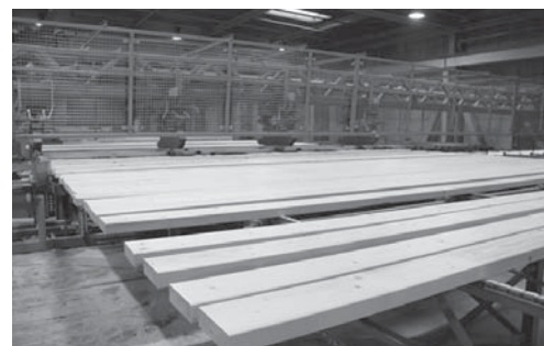
После строгания конструкционная массивная древесина обрезается на необходимую длину
